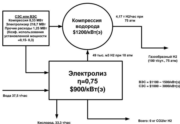
Рис. 10. Схема получения газообразного водорода электролизом воды при использовании солнечной и ветровой энергии [21]
