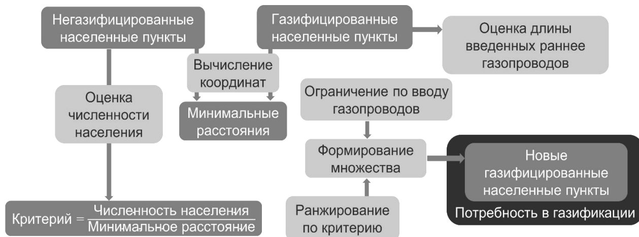
Рисунок 2.2. Схема методики оценки возможности повышения эффективности газификации
