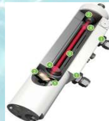
Станция Eddy Covariance на основе газоанализатора CO 2 /H 2 O закрытого типа LI-7200RS, модель LI-7200RSF, LI-COR, модуль воздушного потока 7200-102
