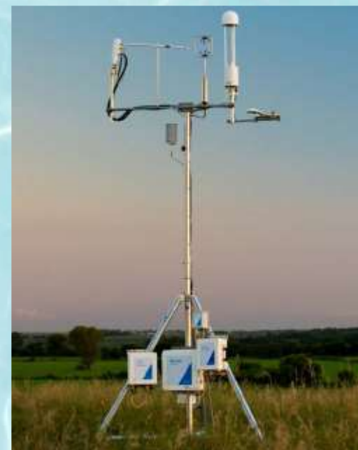
Станция Eddy Covariance на основе газоанализатора CO 2 /H 2 O закрытого типа LI-7200RS, модель LI-7200RSF, LI-COR, модуль воздушного потока 7200-102
