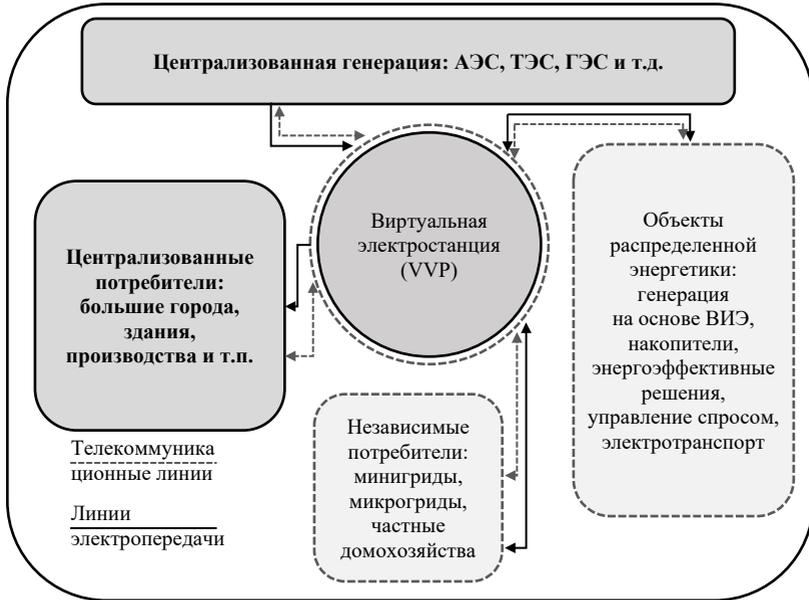
Рисунок 1. Схема архитектуры энергосистемы в распределенной энергетике с выделенными потребителями
