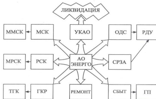
Рис. 9. Базовая схема ликвидации региональных систем энергоснабжения: АО-энерго – региональная система энергоснабжения; УКАО – управляющая компания АО-энерго; МСК – магистральная сетевая компания; ММСК – межрегиональная магистральная сетевая компания; РСК – распределительная сетевая компания региона; МРСК – межрегиональная распределительная сетевая компания; ГКР – генерирующая компания региона (ТЭЦ, блокстанции, тепловые сети, котельные); ТГК – территориальная
