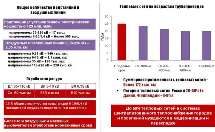
Рис. 5. Износ тепловых и распределительных сетей в РФ
